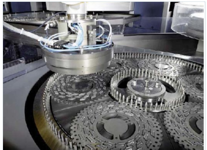
Рис. 2. При шлифовании, доводке и полировке на станках с планетарной кинематикой в цикле обрабатываются детали с очень высокими требованиями к качеству
